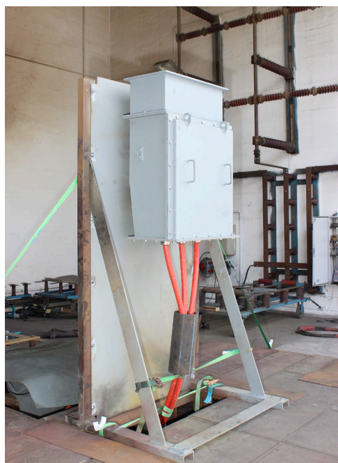
Prüfung vor dem Störlichtbogenversuch im IPH Institut für elektrische Hochleistungstechnik GmbH
