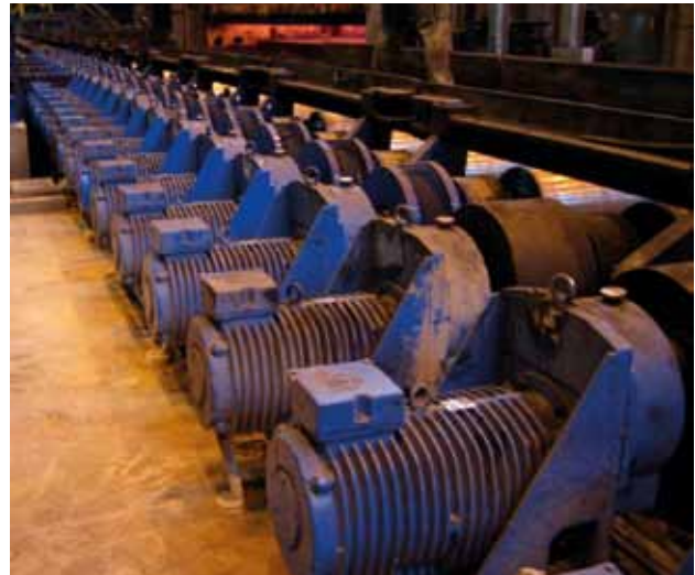
Ofenrollgang mit ARG 200L 12, M_{max}=1888 Nm
