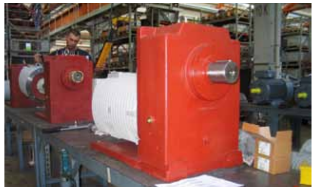
Rollgangausführung, SG200 ARG 200L 8, M_{max}= 1655 Nm
