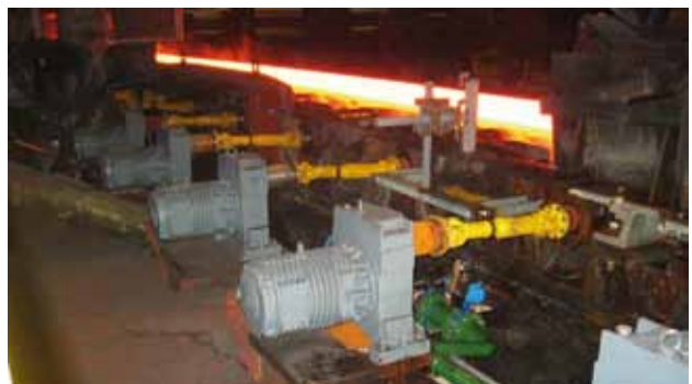
Zwischenrollgang mit S141-1A ARG 160L 4, M_{max}=1039 Nm
