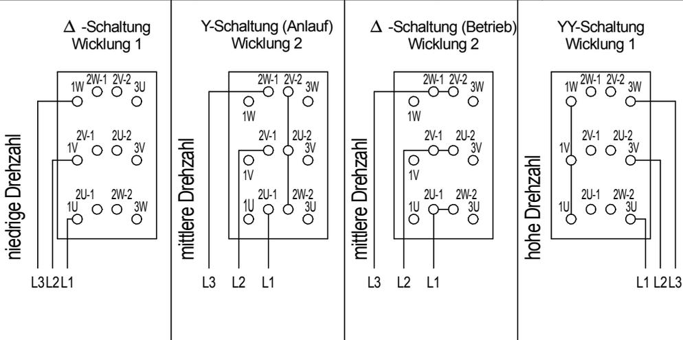
Alle Klemmen zum Polumschalter mit eingebauter Stern-Dreieck-Anlaufschaltung, Sternverbindung für hohe Drehzahl durch Polumschalter.
