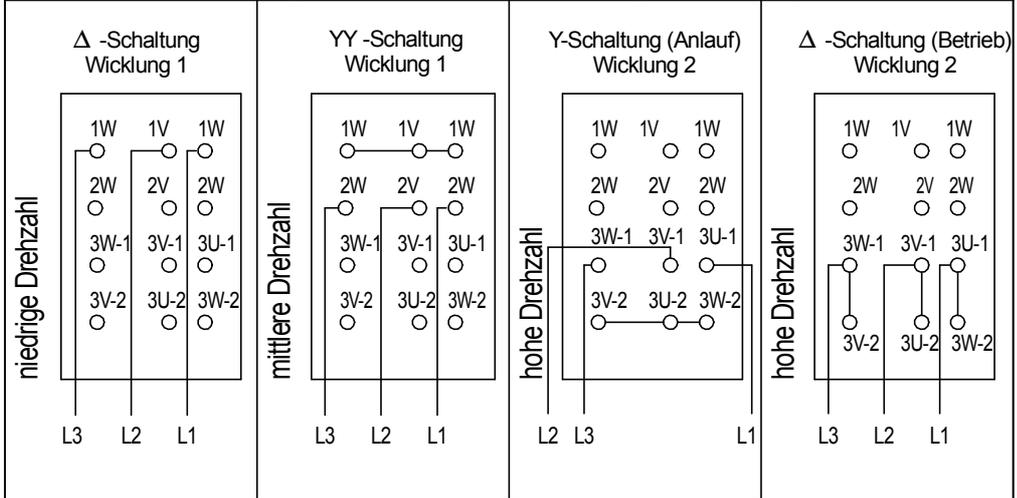
Alle Klemmen zum Polumschalter mit eingebauter Stern-Dreieck-Anlaufschaltung, Sternverbindung für mittlere Drehzahl durch Polumschalter.
