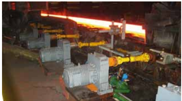
Zwischenrollgang mit S141-1A ARG 160L 4, M_{max}=1039 Nm
