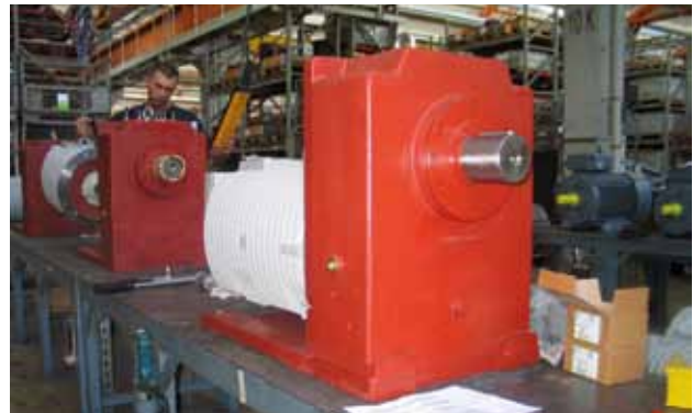
Rollgangausführung, SG200 ARG 200L 8, M_{max}= 1655 Nm
