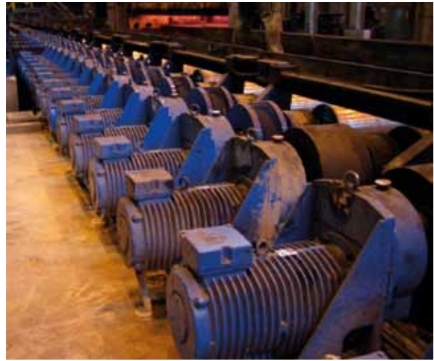
Ofenrollgang mit ARG 200L 12, M_{max}=1888 Nm
