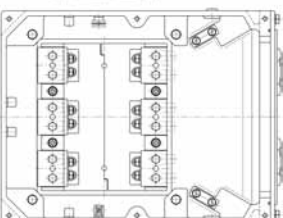
Bild 07G Anschlusskasten 1000 A, Ex eb IIC gerader Zwischenflansch
