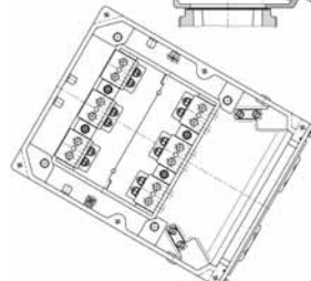
Bild 07S Anschlusskasten 1000 A, Ex eb IIC schräger Zwischenflansch
