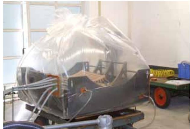
Bild 1.4: Stoßspannungstest an einem Wicklungsmodell unter Gas (Foto: PTB Braunschweig)
